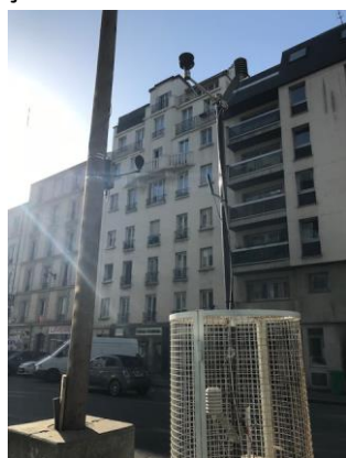
Instrumentation déployée pour la mesure du bruit et des paramètres météorologiques
